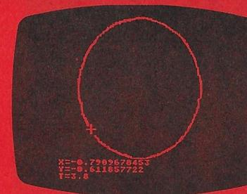
Mit dem Steuerknüppel können Sie für jeden Punkt des Kreises die Werte für X,Y und T abrufen.
